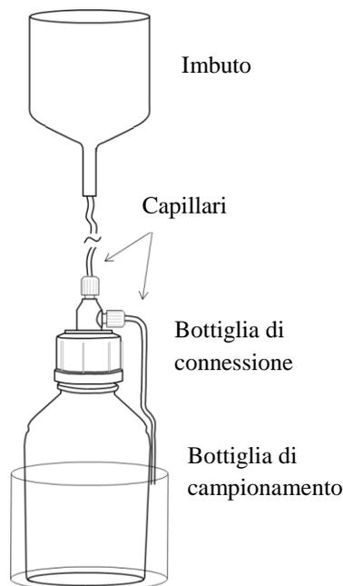
**Figura 3.1.** Esempio di campionatore delle precipitazioni.
